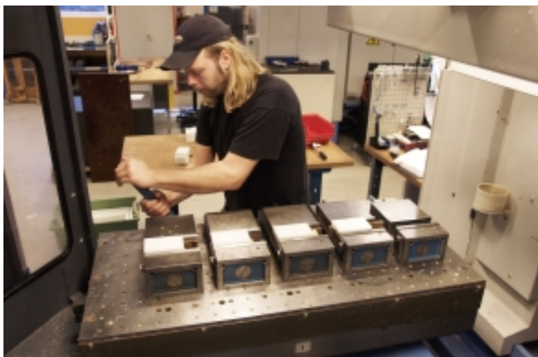
Magnus Johnsson monterar ämnen för bearbetning på växelbordet samtidigt som maskinen arbetar.
